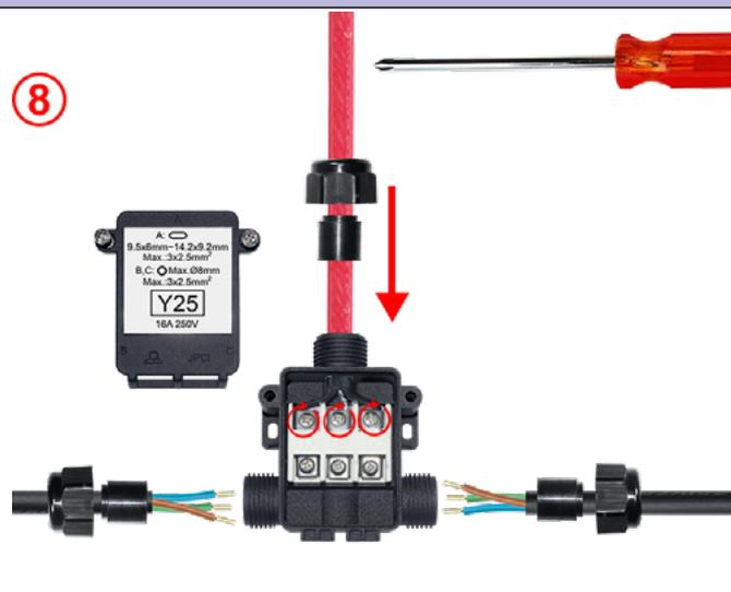
8 : Inserte la parte pelada de los conductores del cable de calefacción en los terminales y apriete con un destornillador. Par de apriete recomendado: 1,2 Nm
