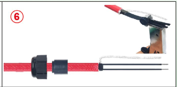
**6:** Corte y retire la sección calefactora entre los dos cables de bus en la longitud solicitada.
