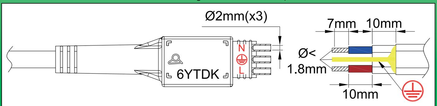
Cable sobremoldeado con termostato anti-congelación incorporado. Para usar en cables de calefacción del tipo paralelo oblongo, autorregulables o de potencia constante. Conexión mediante engarce o soldadura. Aislamiento mediante bota de silicona con relleno RTV
