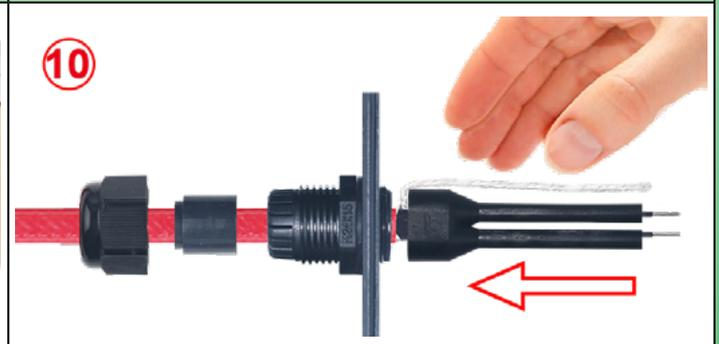
**10:** Deslizar las fundas aislantes sobre los conductores de los cables de calefacción, dejando el conductor de tierra afuera, o con el conductor de tierra adentro si la bota tiene 3 tubos.
