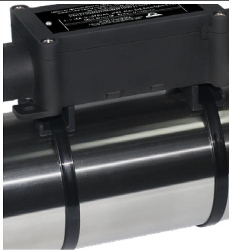
**2:** Dos pestañas de plástico PA66 extraíbles, para colocar en tuberías, proporcionando un desplazamiento de 10 mm desde el tubo. Ideal y económico para aplicaciones con baja espesor de aislamiento y temperatura de tubería por debajo de 100 °C. La sujeción en tuberías de metal o PVC se puede hacer con bridas de nailon o abrazadera metálica (estos elementos vienen incluidos como estándar).
