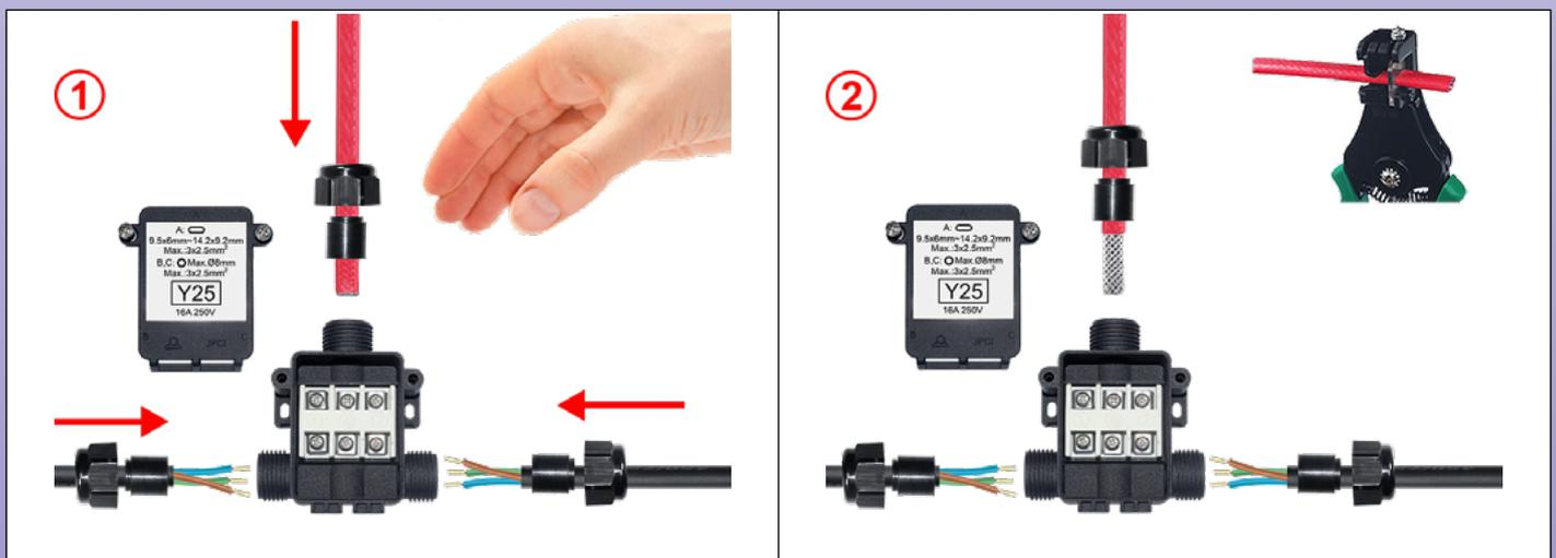
**1** : Pase los dos cables de suministro de energía a través de las tuercas de glándulas de cable B y C, su sello y el cuerpo de la regleta. Retirar el revestimiento exterior y pele los conductores según las dimensiones requeridas.
