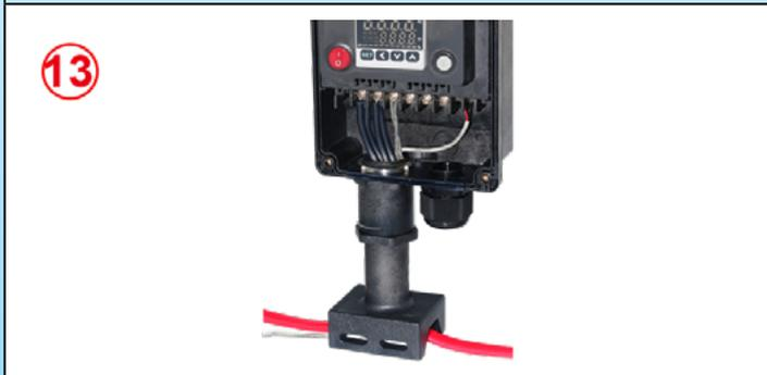
**13:** Conecte los conductores y el sensor de temperatura según el diagrama de cableado. Conecte el cable de suministro de energía. Cierre la caja de control.
