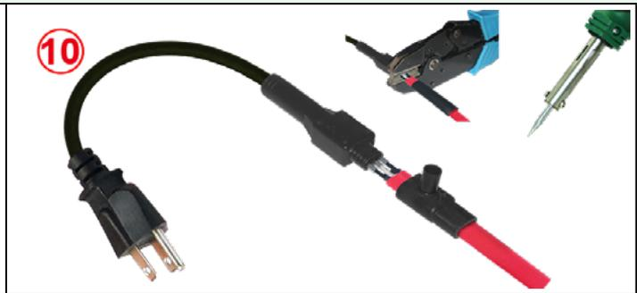
**10:** Inserte los cables en los terminales tubulares y ajústelos con una pinza o soldadura de estaño.
