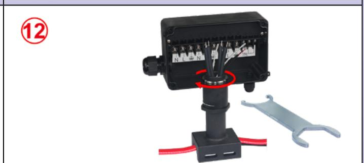
**12** : Coloque la junta en el rebaje superior del pie, luego la caja encima. Oriente la carcasa según la posición deseada, luego coloque y apriete la tuerca dentada hasta que quede bloqueada.
