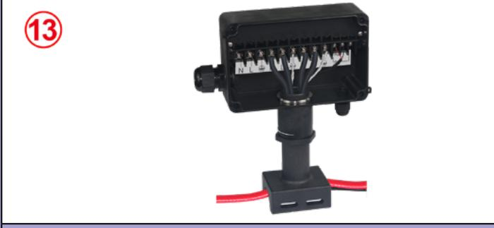
**13** : Conecte los conductores y el sensor de temperatura según el diagrama de cableado. Conecte el cable de suministro de energía. Cierre la caja de control.
