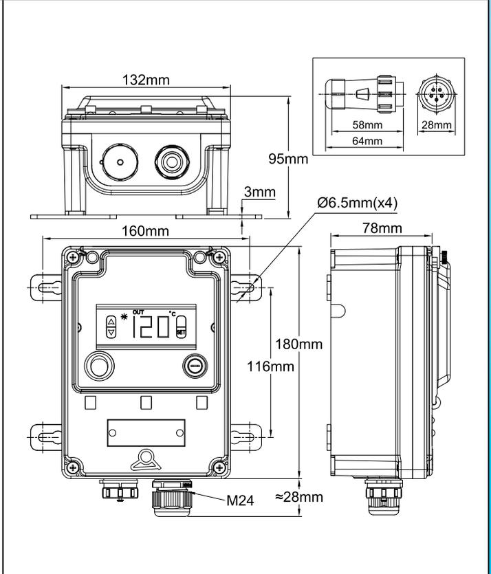
Modelo con 3 glándulas de cable (2 x M24 + 1 x M12):
