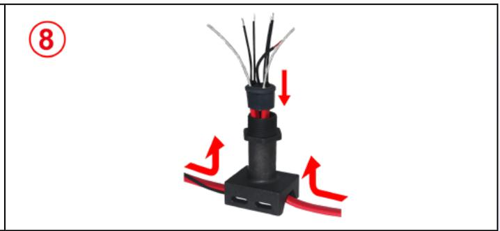
**8** : Coloque el pie sobre los cables de calefacción y sobre el cable del sensor de temperatura, extrayéndolos desde arriba, luego deslice la junta sobre los cables. La cubierta aislante exterior debe sobresalir de la junta de goma.
