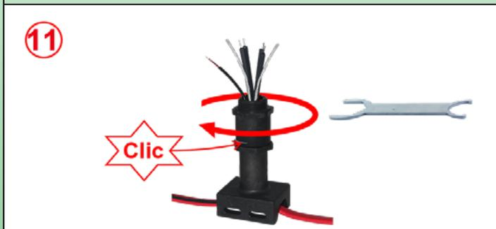
**11:** Comprima el sello al atornillar la parte superior del pie. Al completar el apriete, un pequeño resorte bloquea el conjunto (Para desmontar, es necesario quitar este pequeño resorte semicircular). Luego es posible instalar esta pata a través de un orificio de 32,5 mm en la carcasa seleccionada.
