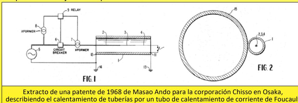
Extracto de una patente de 1968 de Masao Ando para la corporación Chisso en Osaka, describiendo el calentamiento de tuberías por un tubo de calentamiento de corriente de Foucault
