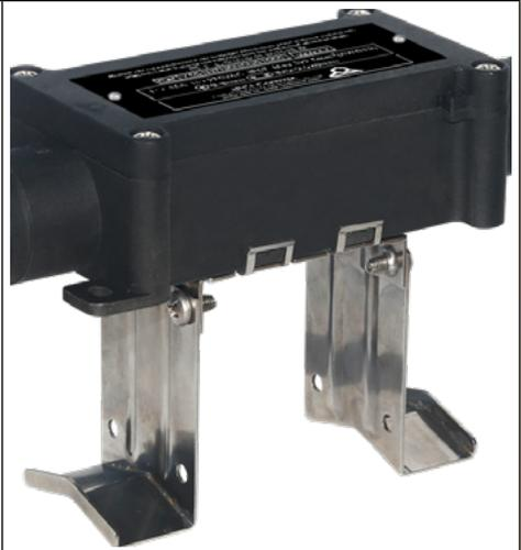
**3:** Un soporte de acero inoxidable, para montaje en desplazamiento en la tubería, que permite cerrar la carcasa después de instalar el aislamiento y su protección. Permite un espesor de aislamiento de 50 mm y se puede utilizar en tuberías calientes. Sujeción en tuberías de metal o PVC con bridas de nailon o abrazadera metálica. (Pies disponibles como accesorio).
