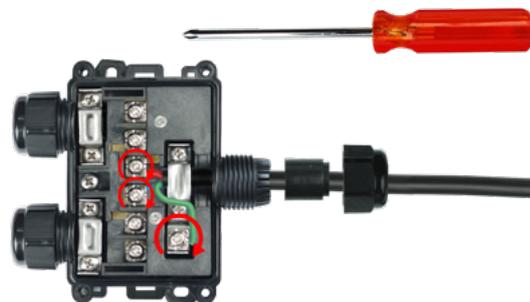
1 : Retirar el aislamiento exterior en el cable redondo según lo solicite el dibujo. Eventualmente, crimpado de zapatas de cable. Deslizar la tuerca de glándulas de cable en el cable. Seleccione la junta compatible con el diámetro y deslícela en el cable.
