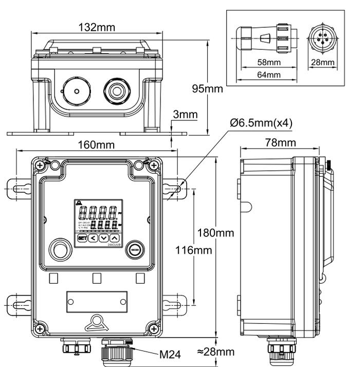
Modelo con 3 glándulas de cable (2 x M24 + 1 x M12):
