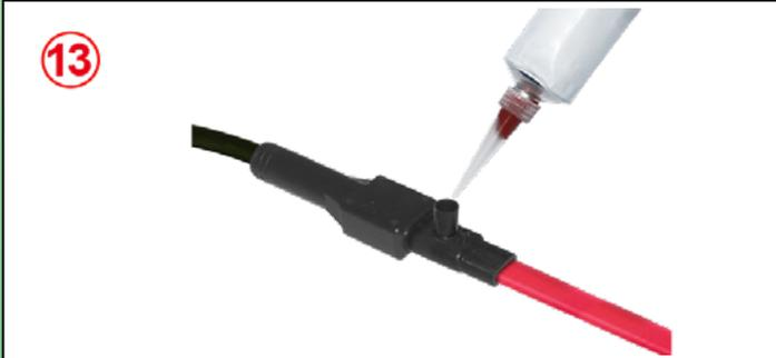
**13:** Ponga en posición horizontal y llene con silicona RTV a través del embudo. Deje curar durante 24 horas. **No energice durante el tiempo de curado.**
