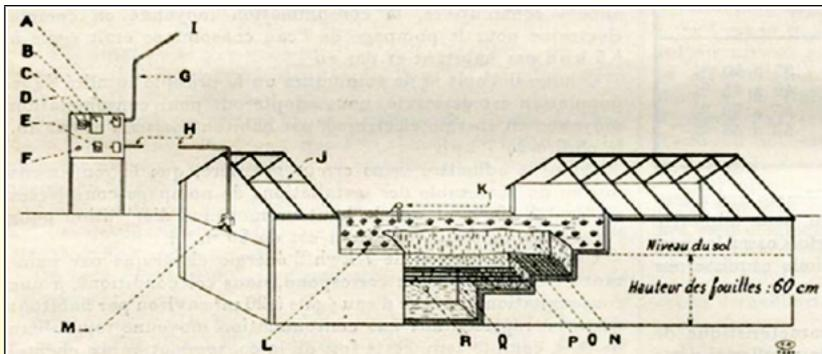
FIG. 1. — Coupe d'une bêche chauffée par câbles électriques.
